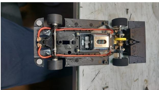
E' possibile utilizzare sistemi di regolazione dell'altezza e posizione dell'assale anteriore mediante l'uso di grani a brugola, purché siano predisposti dal produttore e che i grani non fuoriescano dalla parte inferiore del telaio.
